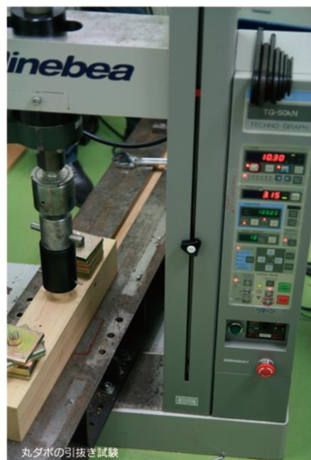
丸ダボの引抜き試験
