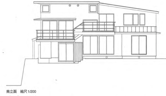
夏の「涼」は「深い軒」と屋根にも仕掛けた通気ルートでつくります。生活空間の熱気は空間最頂部の壁輪廻転動窓からドラフト排出する。外壁部品のセントキップは躯体内換気を担う断熱体の換気層で、サブライは開口部下換気口から取っている。軒の先端部スリットは外壁通気層と結び、壁裡・壁の断熱材を断熱材の外側で排出する。
