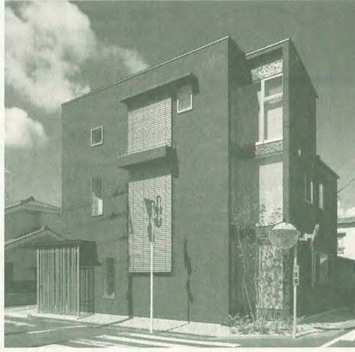
写真3 夏場の東面を外付けルーバーで覆うと効果的（撮影：黒住 直臣）
